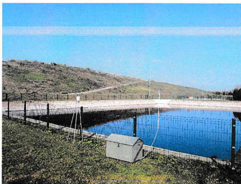
Slika 3: Mjerna aparatura na lokaciji Totovec: aparatura za uzorkovanje plinovitih onečišćujućih tvari i stalak za uzorkovanje UTT
